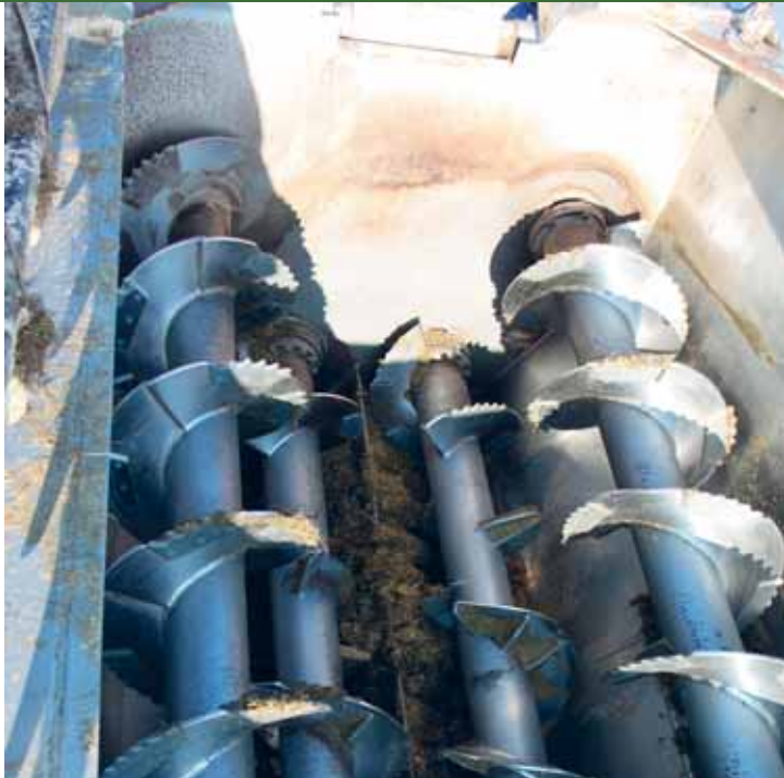
Hoewel deze vijzels en lagers al 11.000 uren meegaan, zijn ze nog lang niet versleten. Wel zijn er nieuwe messen opgeschroefd.
