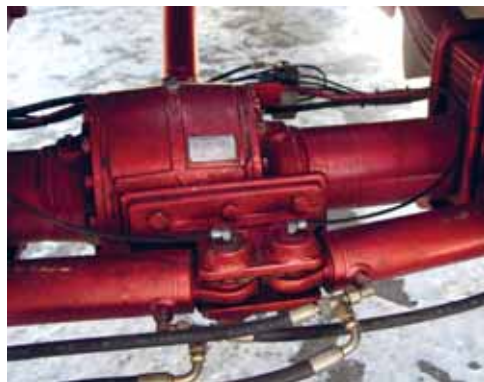
Zware Omsi-as in bladveren, aangedreven door een centrale transmissiebak. Stuurkogels worden gesmeerd.
