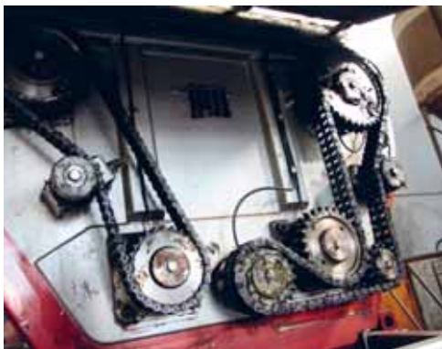
De bovenste vijzels draaien naar binnen. Ze drijven de onderste aan via kettingen.
