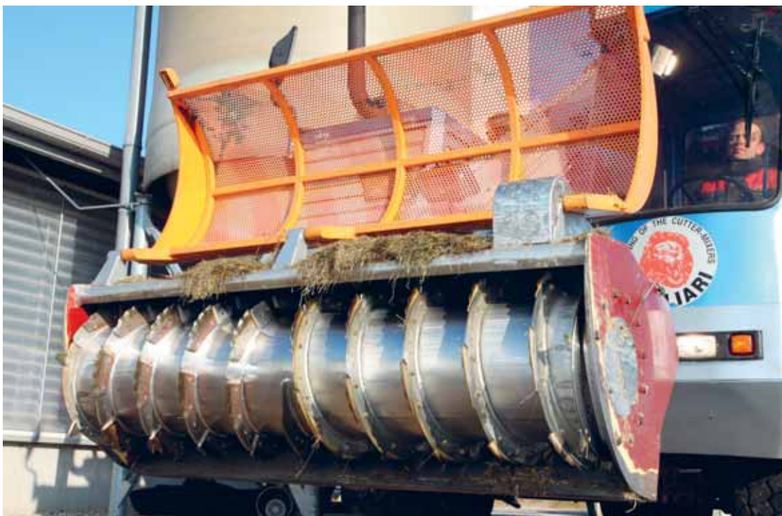
Ook de frees is van roestvaststaal. Aandrijving via beide zijden; hij kan zowel bovenover als onderdoor draaien.
